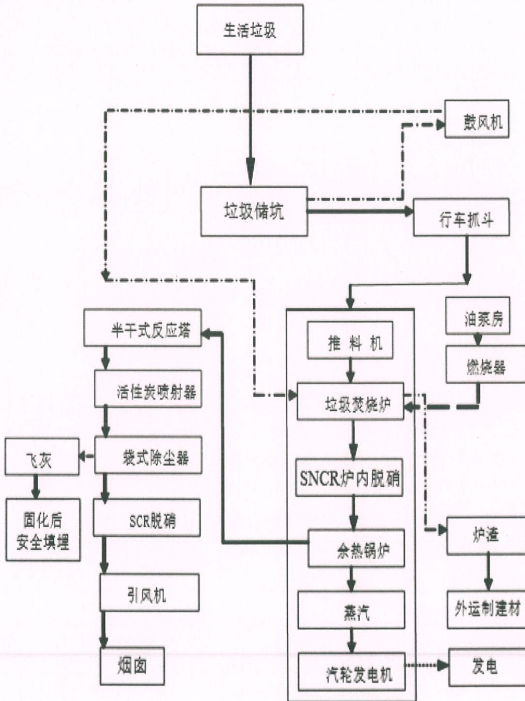
垃圾焚烧处理工艺流程简图
