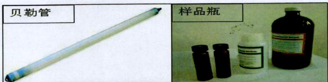
图 5-2 地下水采样与收集工具
